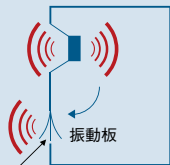
ウーファユニット背面から出た低音振動を、振動板の共振を利用して低音拡大
